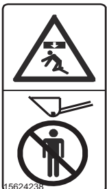
21 ATTENTION ! Ne passez pas sous des bras de levage soulevés. Restez à distance de sûreté de la machine. Numéro de référence aux États-Unis : 15624249.
