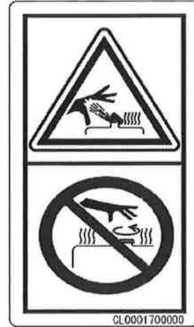
(20) Voorzorgsmaatregelen om het risico op brandwonden te beperken (CL000170000) [2 plaatsen]
