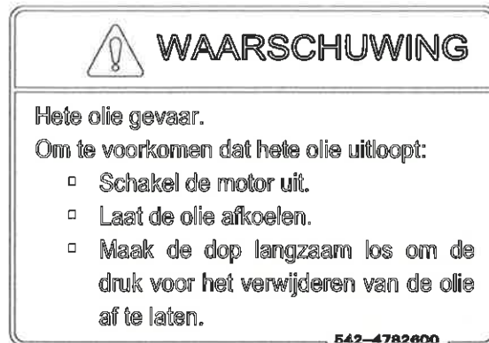
(5) Waarschuwing m.b.t. hydraulische olie (542-4782600)
