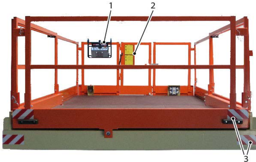
Stickers aan binnenzijde van het platform
