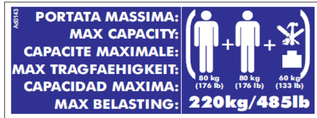
Afbeelding 52: maximaal toelaatbare belasting korf.
