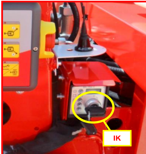
Afbeelding 4: bedieningspost voor start/stop motor.
