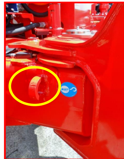
Afbeelding 20: bevestigingspunten op het onderstel.
