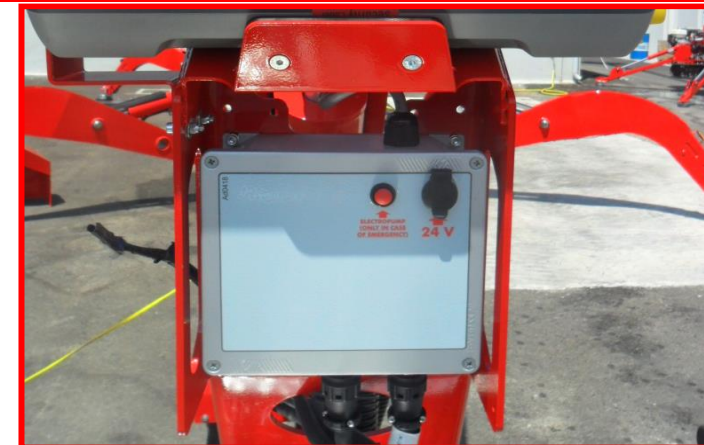
Afbeelding 9: bedieningspost platform in de korf.
