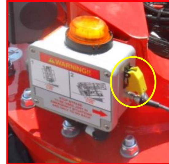
Afbeelding 24: toets voor bypass verplaatsingsblokkering.
