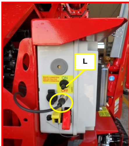
Afbeelding 89: kastje start/stop op het onderstel.
