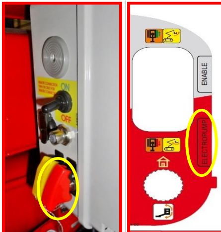
Afbeelding 29: knoppen elektrische pomp.
