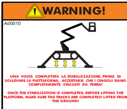
Afbeelding 64: waarschuwing voor stijging rupsbanden.
