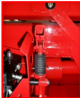
Afbeelding 20: inbrengpunt van de handpomp.
