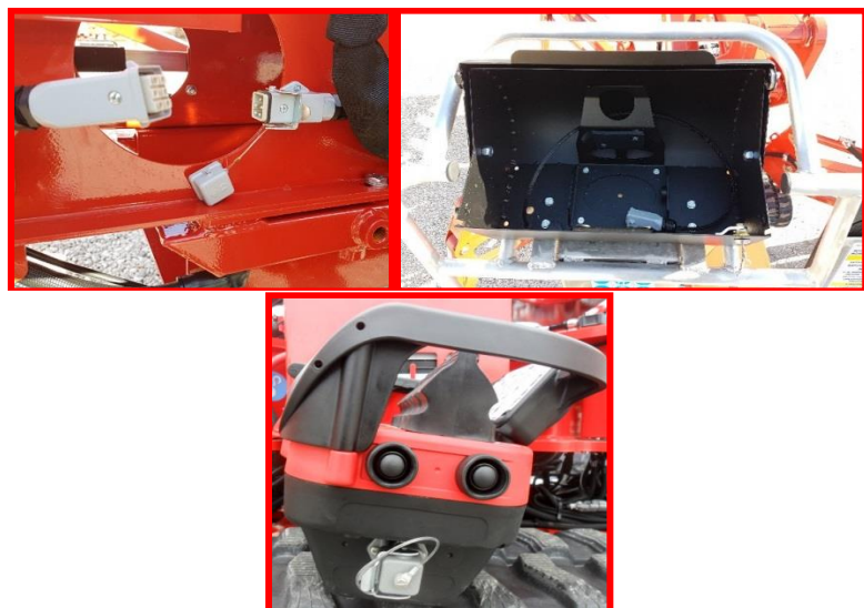
Afbeelding 11: aansluiting op het onderstel en in de korf voor draadafstandsbediening.
