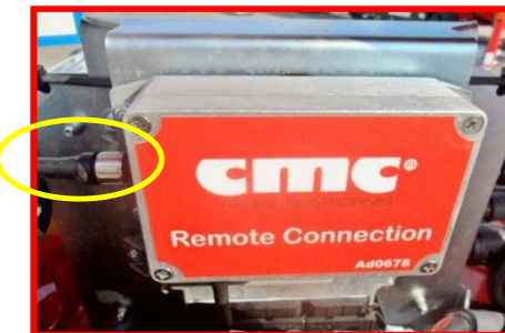
Afbeelding 88: kastje voor verbinding op afstand.
