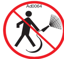
Afbeelding 85: verbod voor het bevochtigen van de hoogwerker.
