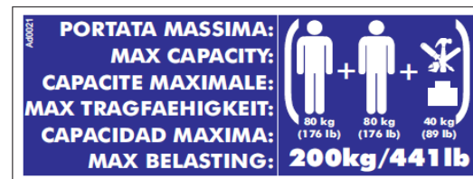
Afbeelding 38: maximale belasting in de korf.
